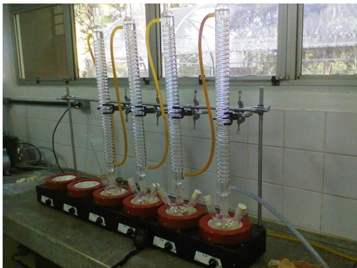
**Figura 13** – Sistema de manta aquecedora e refluxo utilizado na saponificação.
