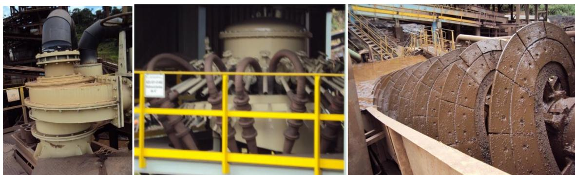
Figura 13: Equipamentos de classificação da usina. A) Hidrociclones de 26”. B) Hidrociclones de 4”. C) Classificador espiral.
