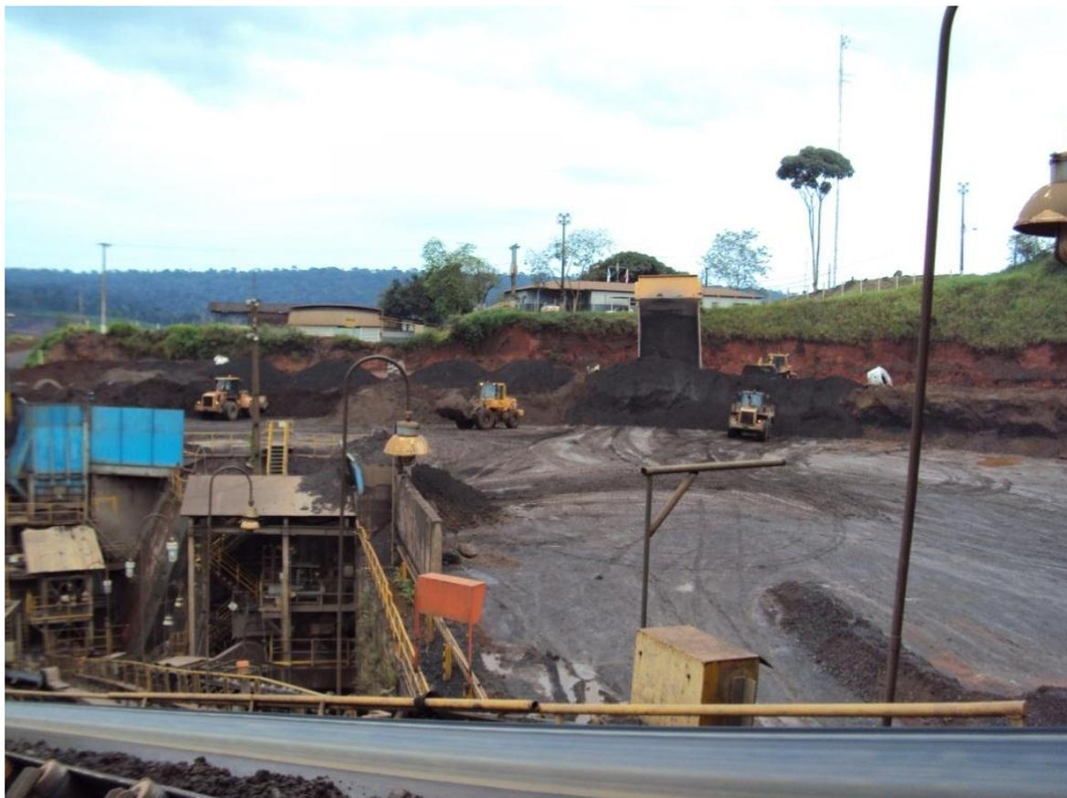
Figura 9: Pilha pulmão da usina. Carregadeiras alimentando os silos.
