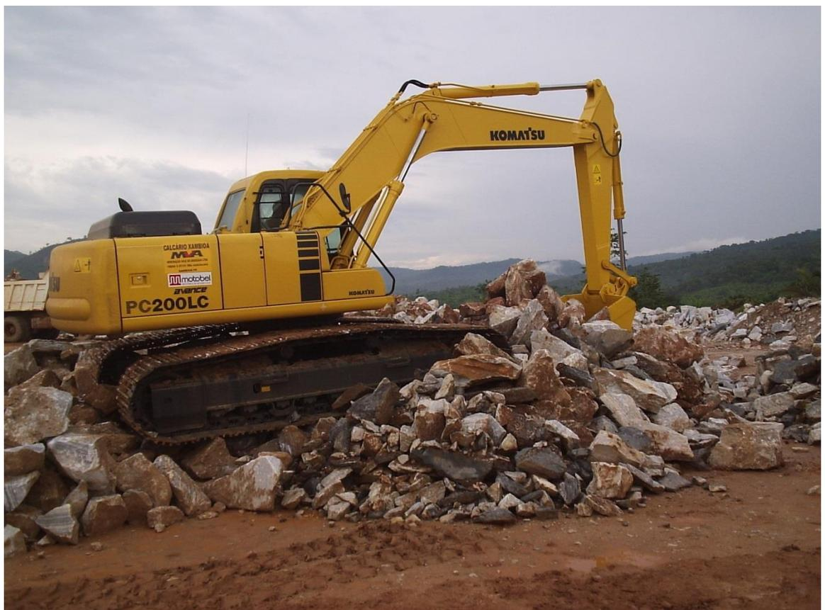
Figura 7: Carregamento por escavadeiras hidráulicas (Fonte: Arquivo Pessoal)
