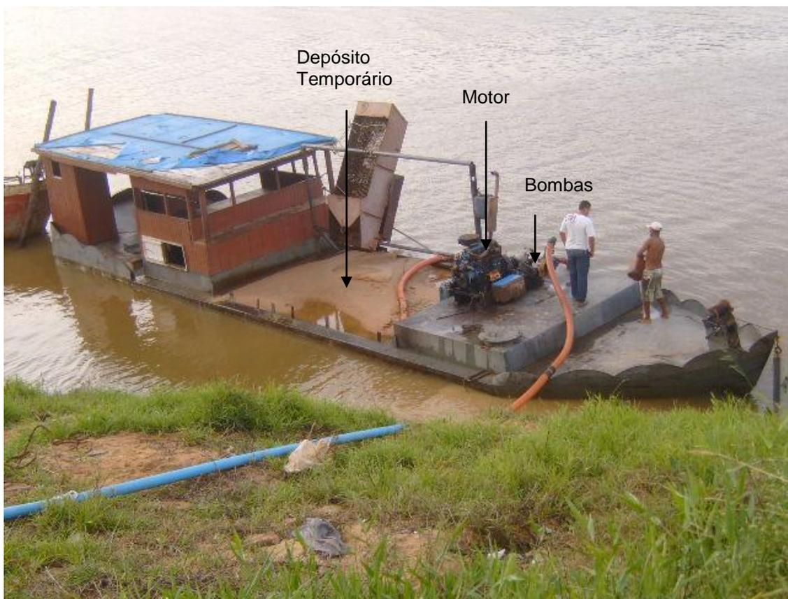
Figura 1.6: Retirada do material das balsas.
