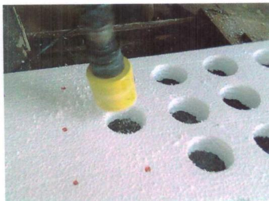
**Figura 8.** Utilização de um serra copos adaptado á uma furadeira elétrica para a perfuração da placa de isopor.
